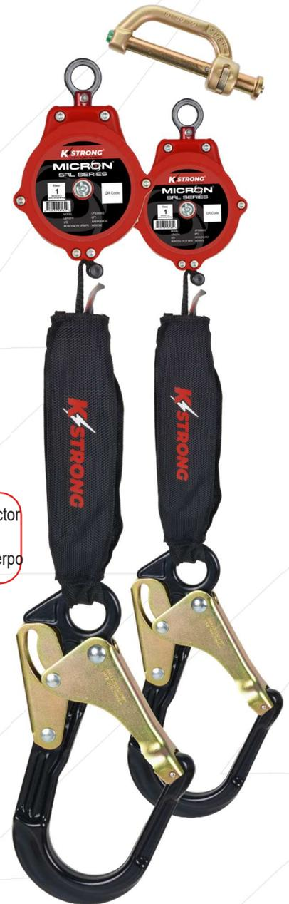
El Micron™ serie de SRL's no solo han sido probadas según ANSI Z359.14-2021, sino también con un factor de caída de 2. Esto significa que cuando no hay un punto de anclaje superior, un trabajador puede conectarse a un anclaje adecuado hasta 5 pies por debajo de la altura del anillo dorsal de su arnés de cuerpo completo.
