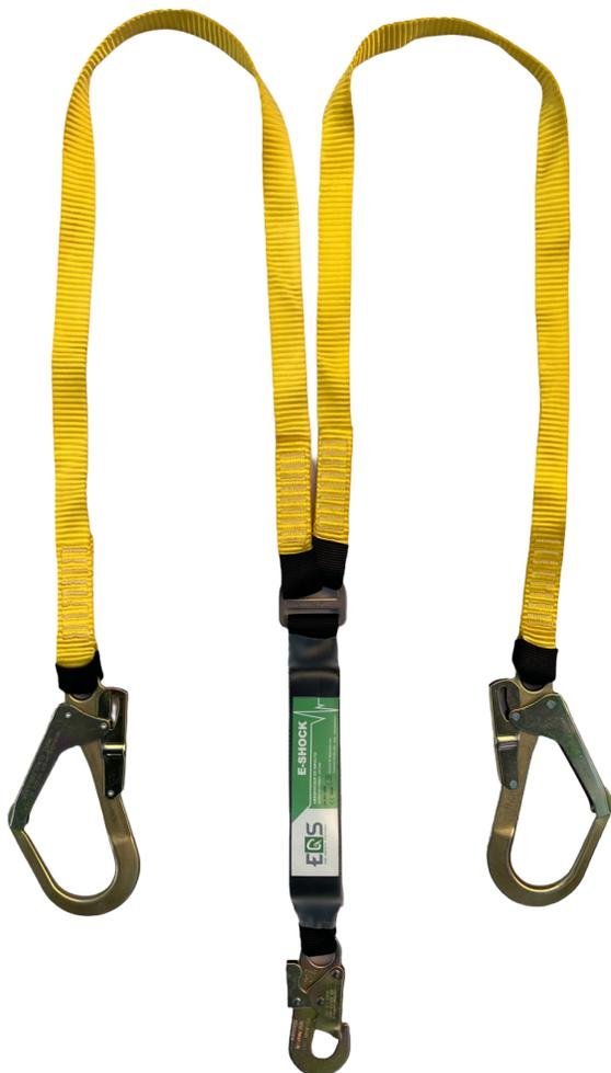
El absorbedor de impacto EQS forma parte de un sistema personal de detención de caídas, es un equipo diseñado para mitigar las fuerzas de impacto que experimenta una persona en caso de una caída desde altura. Esta absorción de energía ayuda a prevenir lesiones al desacelerar gradualmente la caída en lugar de detenerla abruptamente. Este dispositivo reduce la fuerza de impacto ampliando la distancia de desaceleración, permitiendo que la fuerza que recibe el usuario se reduzca a menos de 6kN.
