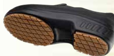
**Suela** Full grip antideslizante, constituida por una capa de goma (pegada directamente a la capellada, con densidad 1,0g/cm<sup>3</sup>), más resistente a objetos cortantes, perforantes y a abrasión por el hecho de ser más compacta, además de ser resistente a la absorción de energía en el talón, al aceite combustible y al deslizamiento en piso cerámico y piso de acero (Categoría SRC).
